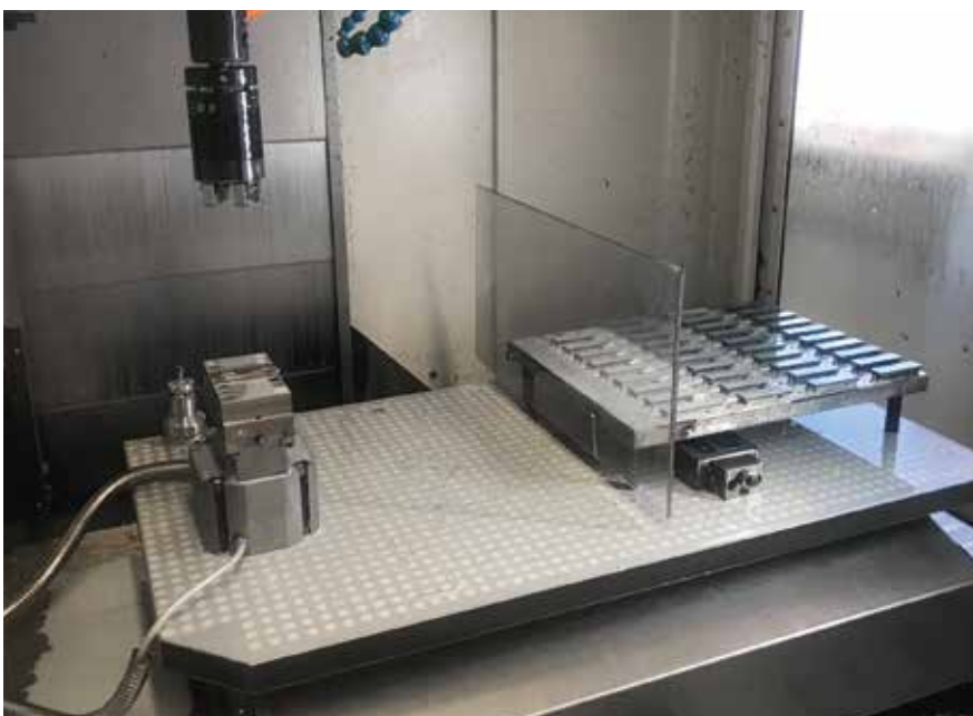
Werkstückgreifer, Aufspannplatte, mit Bohrungsraster und Werkstückablage Workpiece gripper, clamping plate, with grid holes and workpiece tray
