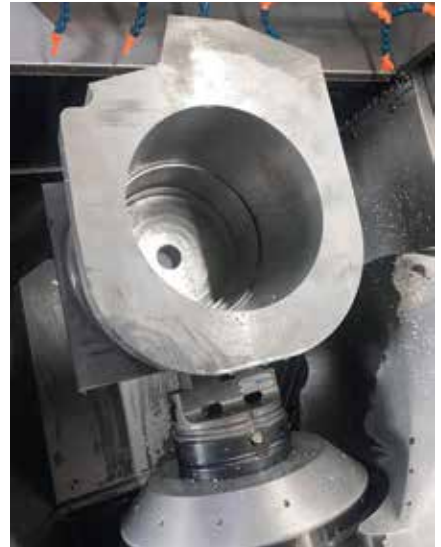
Automationsspanner – Mechanischer Zentrischspanner MZR 160-60 PA Automation vises - Mechanical centre-clamping vise MZR 160-60 PA
