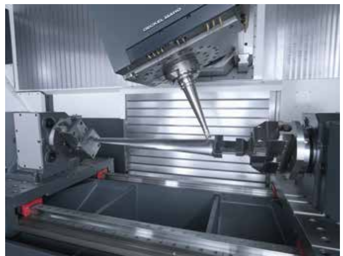
Mechanischer Zentrischspanner MZS 220-80 A auf Blade-Tisch Mechanical centre-clamping vise MZS 220-80 A on Blade-Table Bild / Picture: DMG DMU 100
