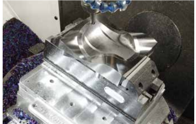
Mechanischer Zentrischspanner MZE 280-100 auf Palettiersystem Mechanical centre-clamping vise MZE 280-100 on a palletizing system
