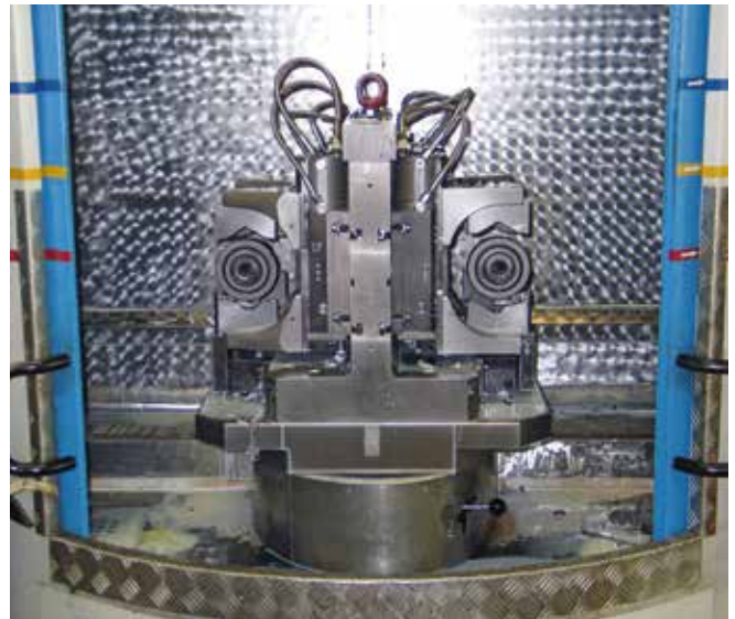
Hydraulischer Zentrischspanner HZS 250-100 D auf horizontalem Bearbeitungszentrum Hydraulic centre-clamping vise HZS 250-100 D on horizontal machining centre
