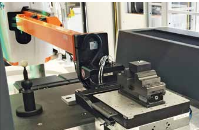
Mechanischer Zentrischspanner MZC 220-80 E auf Palettiersystem Mechanical centre-clamping vise MZC 220-80 E on a palletizing system
