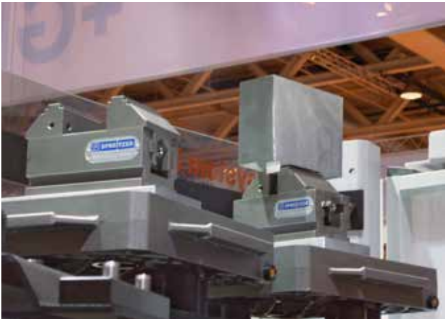
Mechanischer Zentrischspanner MZR 170-60 auf Palettiersystem Mechanical centre-clamping vise MZR 170-60 on a palletizing system
