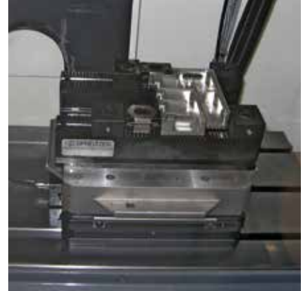
Zwei Mehrfachspannsysteme MMS 260-50-1 auf Palettiersystem Two multiple clamping systems MMS 260-50-1 on a palletizing system
