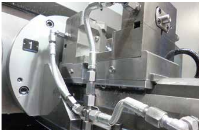
Hydraulischer Zentrischspanner HZS 250-100 A mit Sonderbacken Hydraulic centre-clamping vises HZS 250-100 A with custom designed jaws
