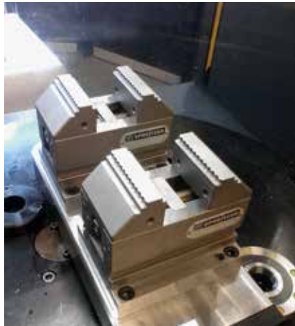
Mechanischer Zentrischspanner MZR 120-60 auf Palette Mechanical centre-clamping vise MZR 120-60 on pallet
