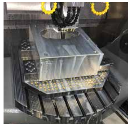
Rasterplatte 20-M10 mit modularen Spannelementen Grid plate 20-M10 with modular clamping elements
