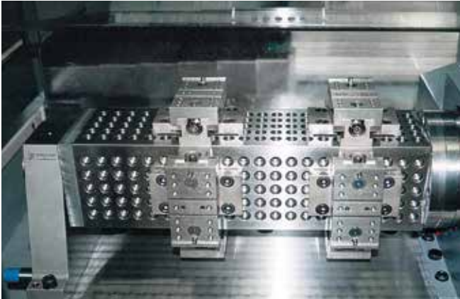
Mechanischer Zentrischspanner MZS 120-60 A auf Spannbrücke zur Mehrseitenbearbeitung Mechanical centre-clamping vise MZS 120-60 A on clamping bridge for multi-side-machining
