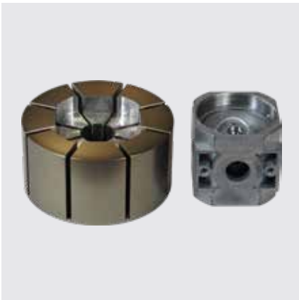
Werkstückkontur eingefräst Milled workpiece contour
