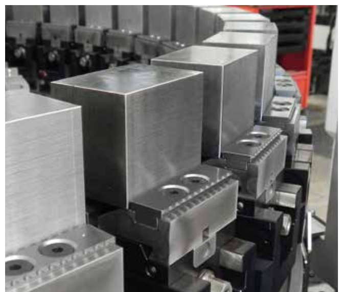
Stufen-Wendebacken mit Gripeleisten Reversible stepped jaws with grip inserts
