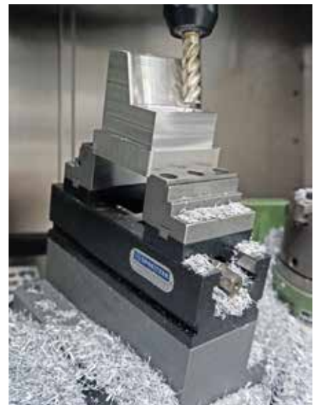
Mechanischer Zentrischspanner MZU 280-100 auf Unterbau Mechanical centre-clamping vise MZU 280-100 on base cube
