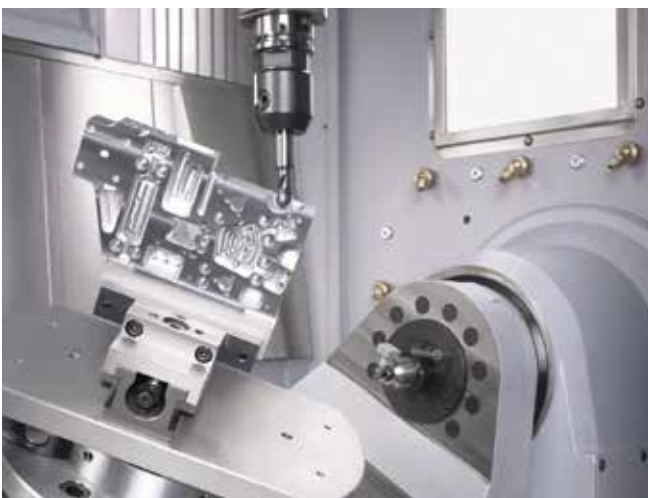
Mechanischer Zentrischspanner MZS 180-80, Ausführung B mit Gripbacken Mechanical centre-clamping vise MZS 180-80, type B with grip jaws
