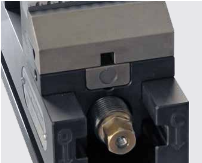
Selbsthemmender Verschlussmechanismus Irreversible locking mechanism
