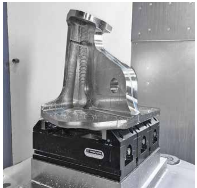
Mechanischer Zentrischspanner MZE 280-100 auf Mehrachs-Bearbeitungszentrum Mechanical centre-clamping vise MZE 280-100 on multi-axis machining centre
