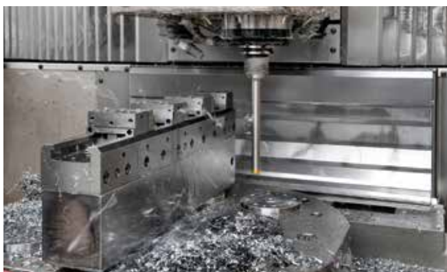
Reinigung von Werkstück und Spannmittel Cleaning of workpiece and clamping devices
