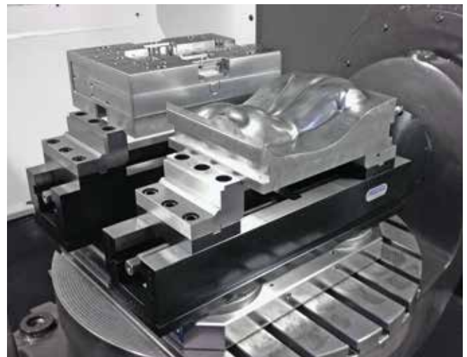
Mechanischer Zentrischspanner MZU 500-125 auf Nullpunktspannsystem Mechanical centre-clamping vise MZU 500-125 on zero-point-system
