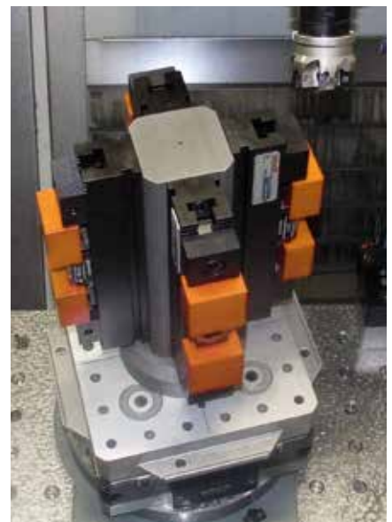
Mehrfachspannsystem MMS 260-50-1 auf Spannturm 90° Multiple clamping system MMS 260-50-1 on a clamping tower 90°
