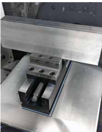
Mechanischer Zentrischspanner MZU 280-100 auf Palettiersystem Mechanical centre-clamping vise MZU 280-100 on a palletizing system
