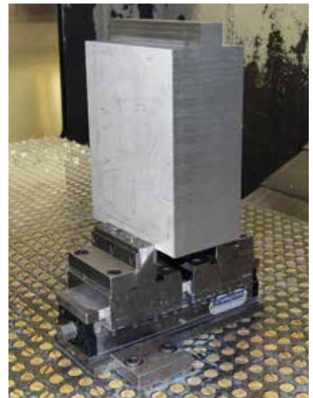
Mechanischer Zentrischspanner MZC 220-80 E, Spannbacken mit HM-Gripeinsätzen Mechanical centre-clamping vise MZC 220-80 E, clamping jaws with carbide grip inserts
