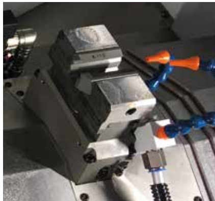
Hydraulischer Zentrischspanner HZS 70-36 mit kundenspezifischen Spannbacken Hydraulic centre-clamping vise HZS 70-36 with customized clamping jaws
