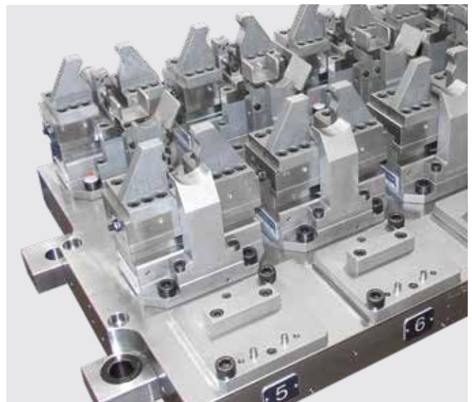
Hydraulischer Zentrischspanner HZS 180-80 A auf Wiegenplatte Hydraulic centre-clamping vises HZS 180-80 A on a swivel plate
