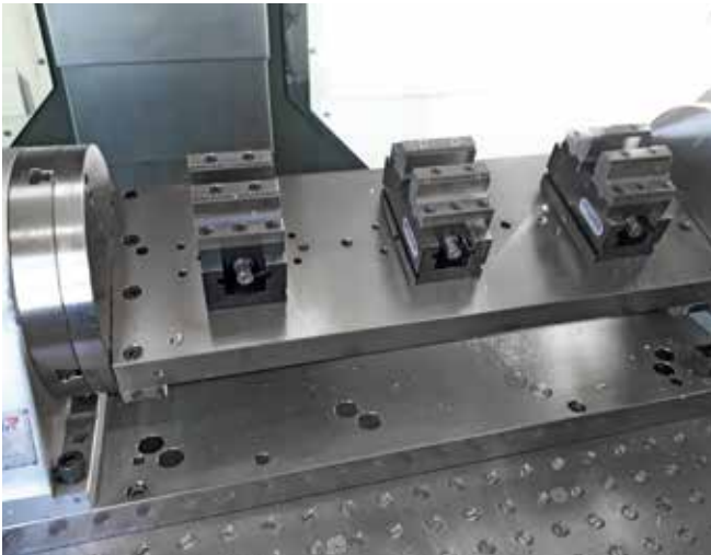
Mechanischer Zentrischspanner MZU 150-80 auf Spannbrücke Mechanical centre-clamping vise MZU 150-80 on bridge unit
