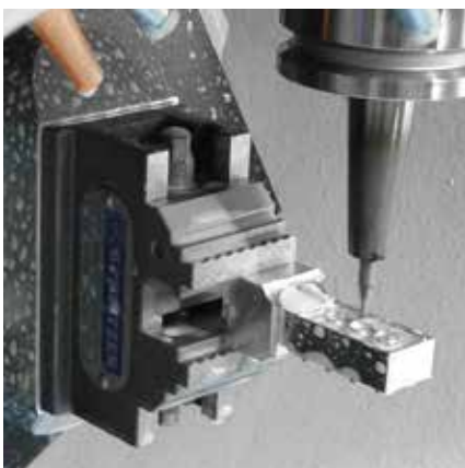
Mechanischer Zentrischspanner MZR 80-36 Mechanical centre-clamping vise MZR 80-36
