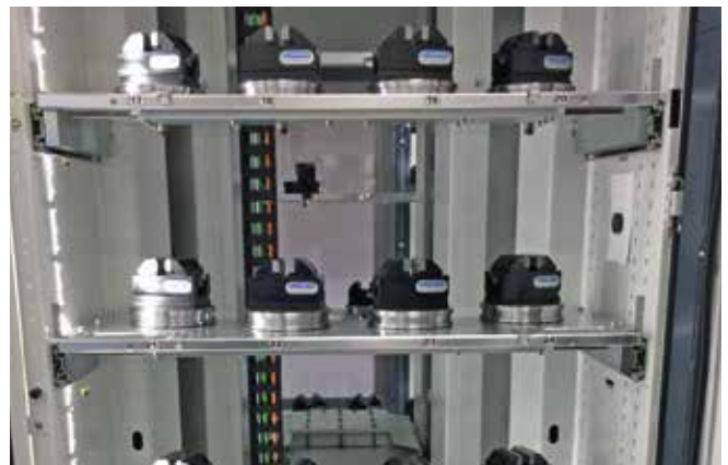
Mechanischer Zentrischspanner MZE 120-60 auf Palettiersystem Mechanical centre-clamping vise MZE 120-60 on a palletizing system
