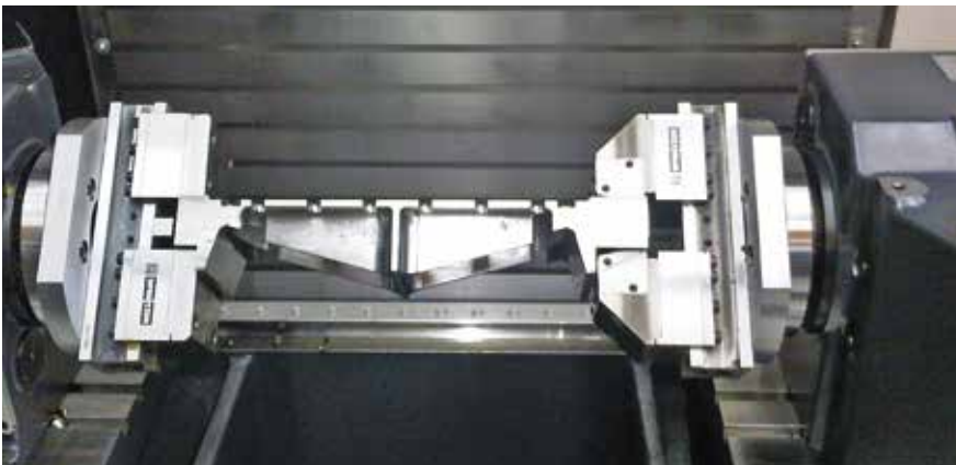
Mechanischer Zentrischspanner MZS 220-80 A montiert auf 4. Achse Mechanical centre-clamping vise MZS 220-80 A mounted on a 4th axis
