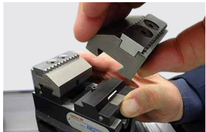
Spannbackenwechsel in Sekunden, ohne Werkzeug! Changing jaws within seconds, without using tools!
