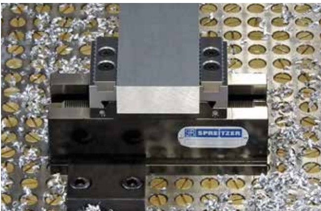
Stufen-Wendebacken mit Gripeleisten Reversible stepped jaws with grip inserts
