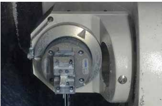
Pneumatischer Zentrischspanner PZS 2 120-60, Stufen-Wendbacken mit Gripleisten Pneumatic centre-clamping vise PZS 2 120-60, reversible stepped jaws with grip inserts
