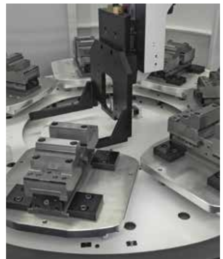
Mechanischer Zentrischspanner MZC 280-100 S auf Palettiersystem Mechanical centre-clamping vise MZC 280-100 S on a palletizing system
