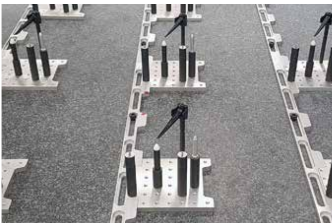
Anschlussleisten mit Paletten Docking rails with pallets
