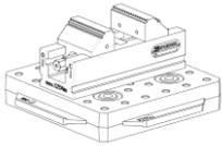
Backenbreite: 80 mm      Spannweite: 178 mm
