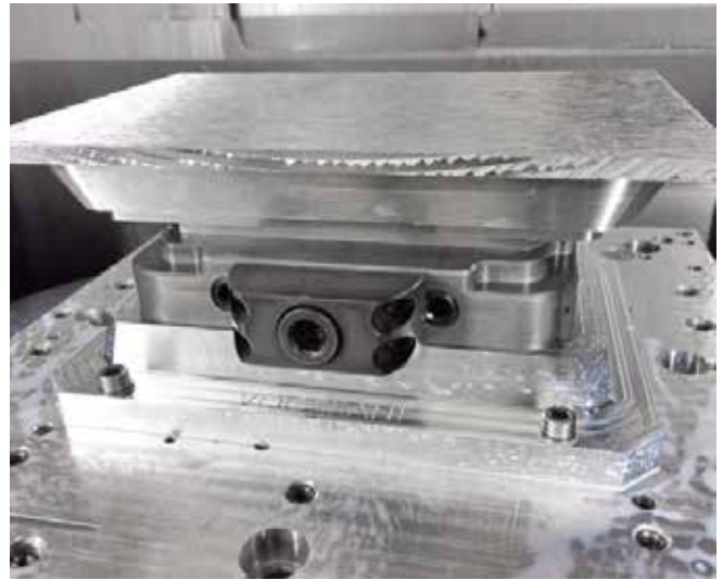
Kundenwerkstück, Spannzapfen direkt eingeschraubt Customer's workpiece, chucking spigots directly screwed
