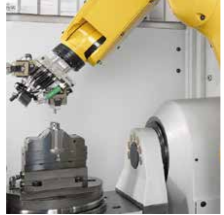
Hydraulischer Zentrischspanner mit Sonderbacken Hydraulic centre-clamping vise with customized jaws
