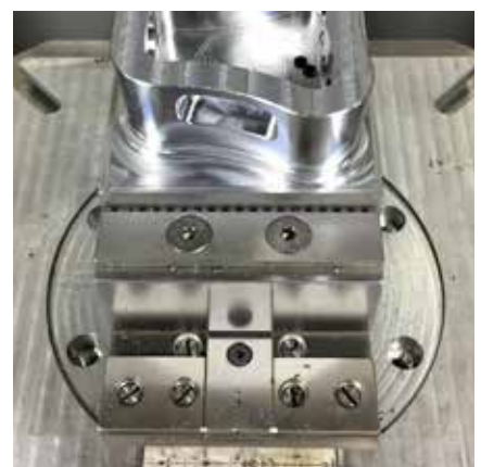
Stufen-Wendebacken mit Gripleiste Reversible stepped jaws with grip insert
