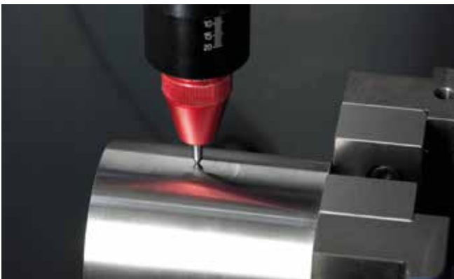
Werkstückkennzeichnung direkt im Fertigungsprozess Workpiece marking directly during the manufacturing process
